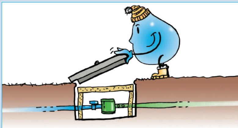
En période hivernale, pensez à protéger votre compteur du gel en le recouvrant d'un matériau isolant comme la mousse de polyéthylène ou une plaque de polystyrène. Les matériaux absorbant l'humidité ne doivent surtout pas être utilisés : paille, textile, papier, laine de verre ou de roche, etc. Attention, votre compteur est sous votre responsabilité, que vous soyez propriétaire ou locataire. S'il est détérioré, le remplacement pourrait se faire à vos frais.
